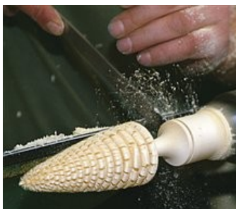
角材を円錐形に挽き、突きノミで枝葉を削りだす 角材から球を作り、突きノミで球面に花びらを作る
