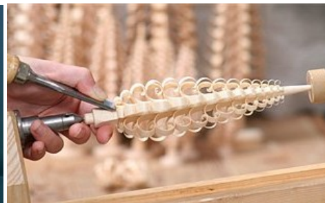
円錐形のボダイジュ材を巻き毛状に削る Spanbaumstechen
